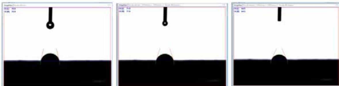
Joonis 2. Facade'i peale kukutatud veepiisk. Fotod ajahetkedel 2, 10 ja 20 minutit
