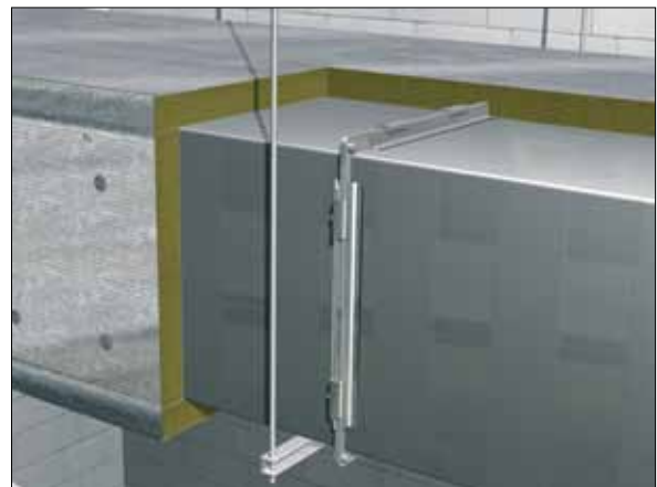
Horizontaalsuunaliste neljakandilise ristlõikega kanalite paigalduspõhimõte
