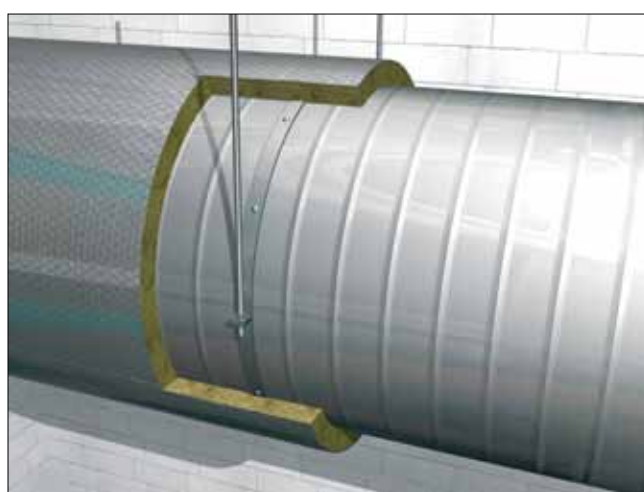
Ümmarguse ristlõikega rõhtkanalite paigalduspõhimõte.
